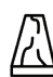
Bloque de madera de 2" x 4" (tamaño real de 1-1/2" x 3-1/2" [38 mm x 89 mm])
